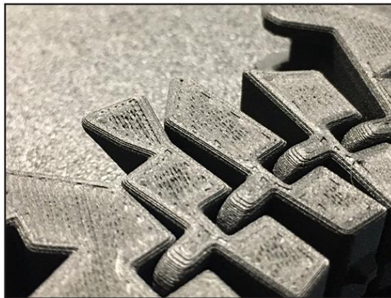
一般而言，垂直壁面上的瑕疵並不是出料不順導致的結果。如果您的列印零件有垂直壁面瑕疵，而且您不確定原因為何，請聯絡 Markforged 支援部門。
