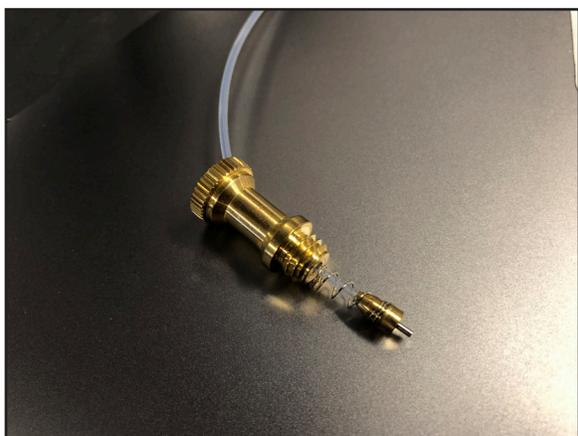
**重要：**請勿將 *PTFE* (塑膠元件) 從壓出機上的金屬插件取下。替換用的纖維遠端送料管會以組件型式提供，而且金屬管已接在上面。若將管子從金屬插件中取下，將會需要換掉整個遠端送料管。
