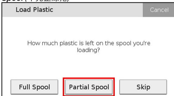
7. 如果選取 **Full Spool** (完整線捲), 請跳至步驟 8。如果選取 **Partial Spool** (不完整線捲), 請依照下列額外步驟, 向印表機提供正確的重量資訊:
