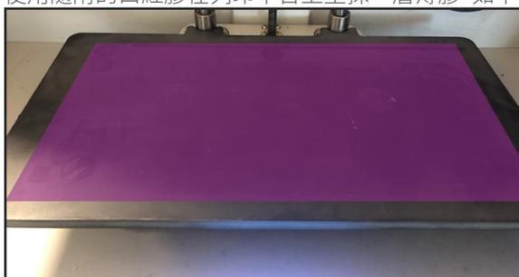
4. 在印表機的觸控螢幕上選取 **Menu (功能表) > Utilities (公用程式) > Test Prints (測試列印) > Bed Level Test Print** (平台水平測試列印), 以執行「Bed Level Test Print」(平台水平測試列印) 公用程式。
