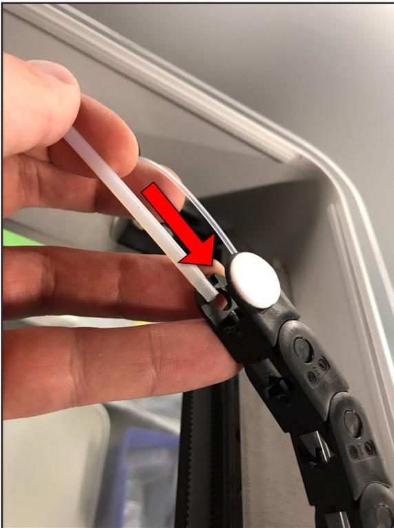
4. 當遠端送料管完全穿過能源鏈後，請安裝下列五金零件：
