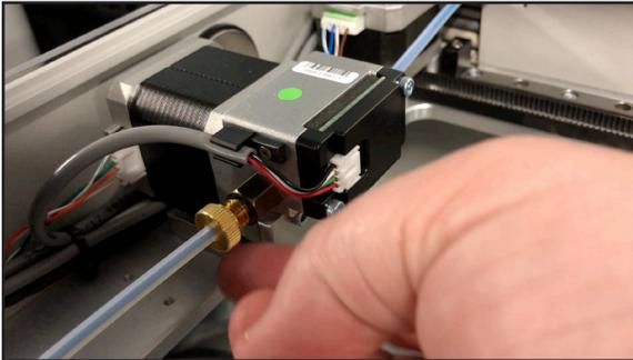
6. 在遠端送料管**靠列印頭的那一端**，小心將套圈插入適當的開口中。現在，將靠列印頭那一段的管子的固定螺絲半鎖至列印頭中。將其鬆開，然後用手指將管子的固定螺絲鎖進列印頭中。
