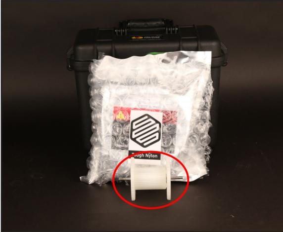
2. 確認塑膠線材的材料袋沒有破洞後，請將線捲從包裝中取出。將隨附的袋裝乾燥劑放在乾燥盒的角落。
