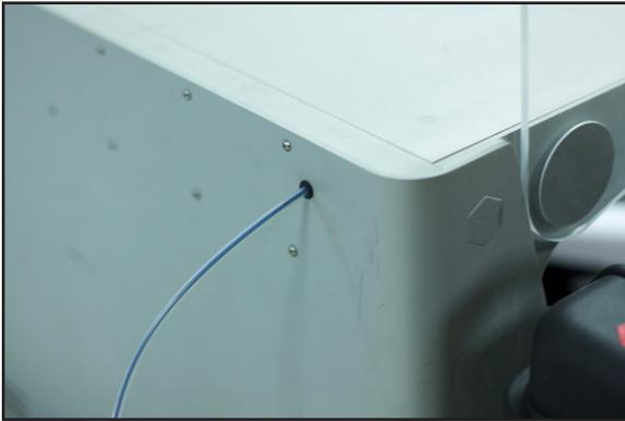
9. 在印表機的觸控螢幕上選取 **Menu (功能表) > Materials (材料) > Load Plastic (裝載塑膠) > Meter Load (測量裝載)**，以執行「Load Plastic」(裝載塑膠) 例程序。請輸入您要裝載的塑膠類型，然後選取 **Full Spool (完整線捲)**。請依照畫面上的指示裝載塑膠，然後再移至下一節。
