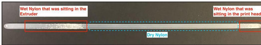
如果您列印成品的斑點看起來比敘述中的更粗糙，請考慮再次執行列印作業。重新列印清除線可確保第二次列印成品中的幾乎所有尼龍都來自乾燥盒。如果第二次列印成品也有粗糙的表面，則乾燥盒中的尼龍可能已暴露在水氣中。
