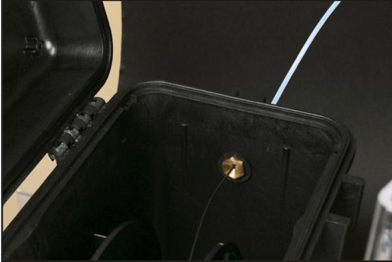
9. 確認沒有殘留物或斷裂的塑膠線材留在印表機中。若您有發現任何殘留物，請先詳閱清潔遠端送料管一節，再接著閱讀這些指示。
